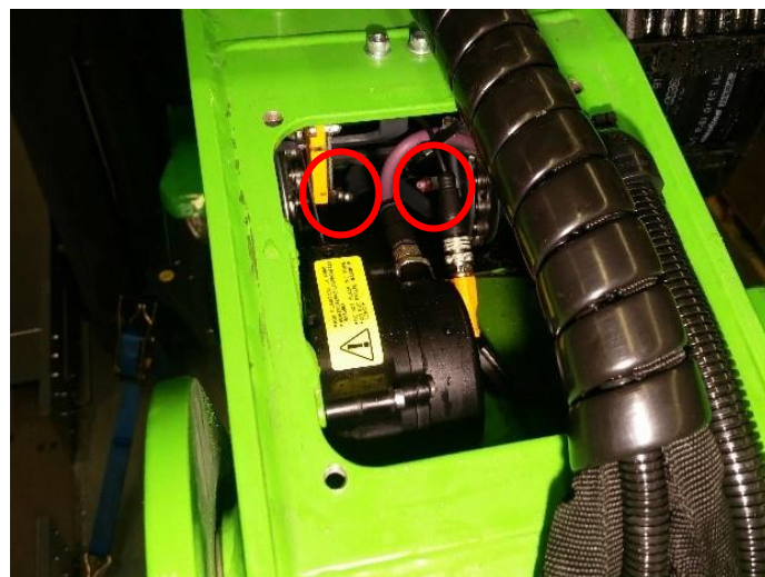
Kuva 17 Levykimppuketjun rasvauskohdat yläpuomin etupäässä
